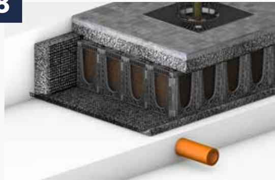
Rellene y compacte la subbase circundante hasta las elevaciones originales, incluidos los geotextiles.
