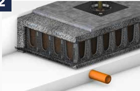
Corte con una sierra los adoquines o la superficie del pavimento de la zona afectada y retírelos.
